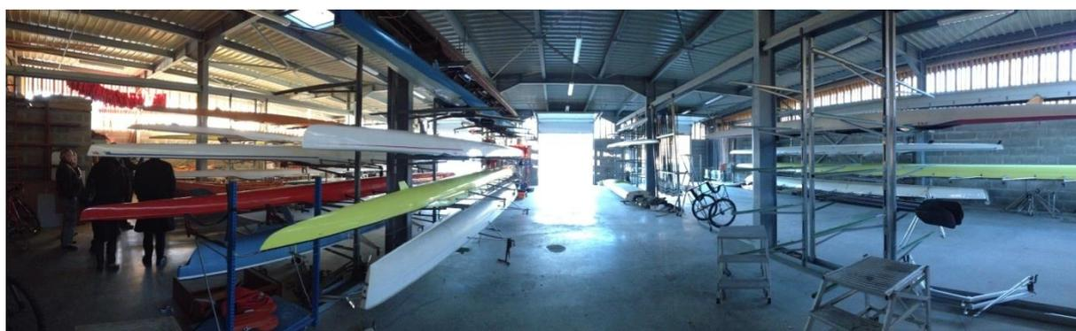
Les travées sont larges, les supports de coques sont réglables en hauteur et longueur de façon à être modifiés facilement. L'éclairage zénithal est très satisfaisant. Une travée est consacrée à l'entretien et la réparation ; une autre dispose de deux ouvertures opposées, permettant l'accès et le dégagement facile d'un véhicule attelé. Un local anti-effraction et ventilé sert à stocker l'essence et les moteurs des coques de sécurité.
